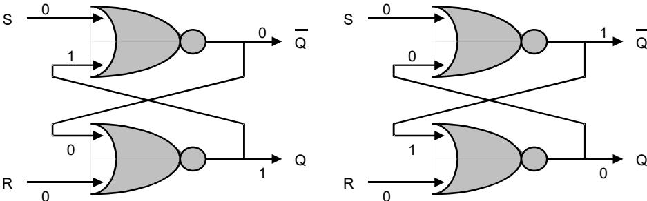
configurazione stabile A      configurazione stabile B
